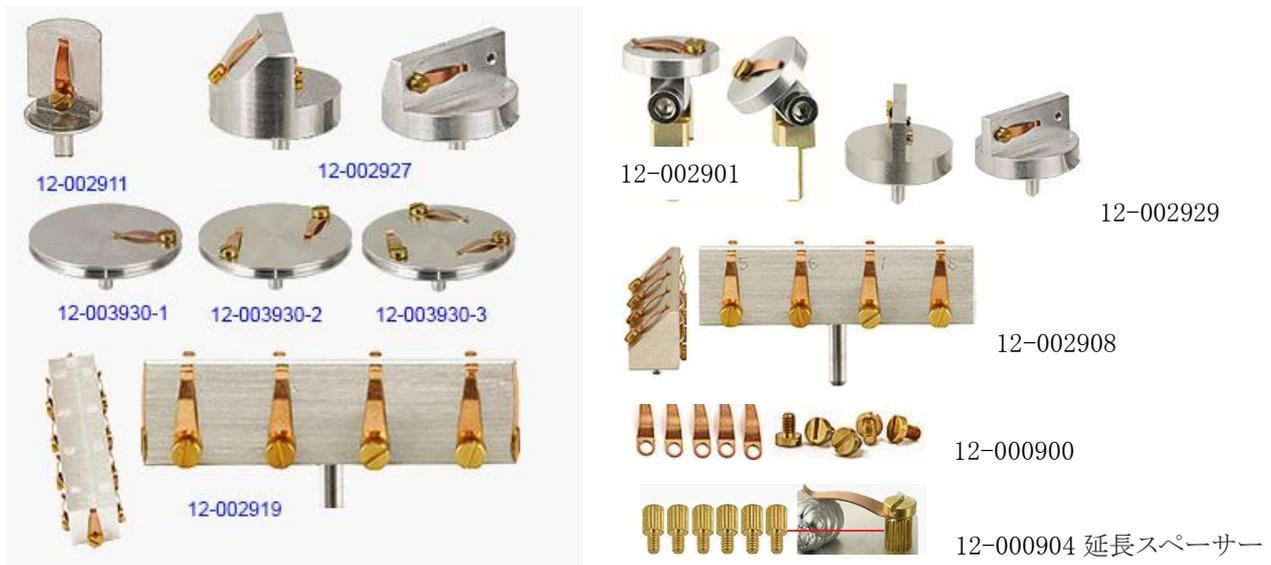
The EM-Tec S-クリップサンプルホルダーは多様な形状の試料をバネとネジで固定する S-クリップ付きのピンスタブ試料ホルダーです。バネ仕掛けの S-クリップは、ホルダーに 2mm の薄標本を保持するように設計されています。オプションで厚みのある試料固定用に 4mm の延長スペーサーを用意しています。S-クリップは回転可能で M2 ネジで取付けられます。S-クリップの材質は導電性銅合金です。試料は、導電性接着剤又は導電性ペーストを必要とせずに確実に保持されます。試料の交換は、簡単、迅速かつクリーンで、接着剤による汚染の問題は解消されます。
